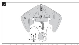
Insert bushings (B) on the Acerbis tank (A). Mount the original tap (N) and the two provided (H) on the center using the screws (S). Check that their O-Rings are still in the right place. Inserire sul serbatojo Acerbis (A) le boccole (B). Montare centralmente il rubinetto originale (N) ed i due in dotazione (H) tramite le viti (S) facendo attenzione che siano correttamente inseriti i loro O-Rings.
