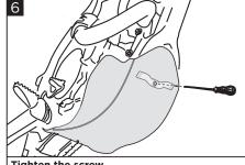
Tighten the screw. Avvitare la vite.
