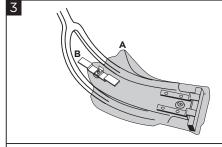
Insert the skidplate (A) in the frame. Inserire il sottomotore (A) nel telaio.
