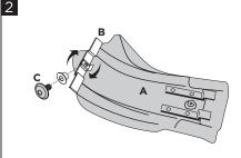
Screw two turns the screw (C) on the bracket Avvitare per due giri la vite (C) alla staffa (B).
