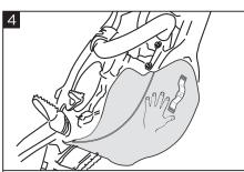
Push the skid plate. Premere il sottomotore.
