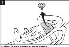
Remove the original protection. Smontare la protezione originale.
