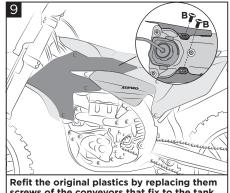
screws of the conveyors that fix to the tank with those supplied (B). Rimontare le plastiche originali sostituendo le viti dei convogliatori che si fissano al serbatoio con quelle in dotazione (B).
