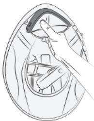
Um das Kinn zu entfernen, schrauben Sie zuerst den Kinnenschutz auf der Innenseite ab.
