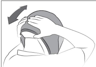
Abróchese el casco y, cogiendo el protector de barbilla con una mano, con la otra intente quitarse el casco con fuerza por la parte posterior. Si el casco pudiera sacarse de esta manera, la talla no es la correcta o no se ha colocado y abrochado correctamente.
