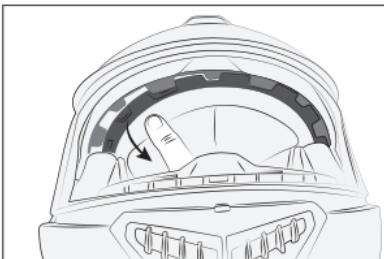
Retirez la partie avant en détachant doucement l'intérieur le long du cadre. Pour faciliter l'opération, commencez par le côté C du cadre.
