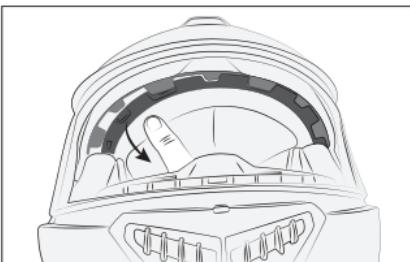
Remova a parte frontal soltando o interior ao longo da estrutura suavemente. Para facilitar a operação, comece pelo lado c e pela estrutura.
