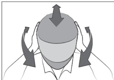
Ora prova a fare quello che noi chiamiamo “**ROLL OFF TEST**”
