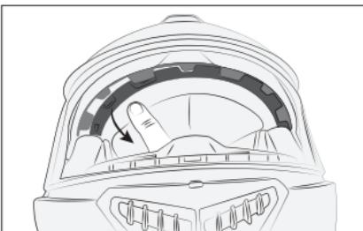
Rimuovere la parte frontale sganciando l'interno lungo il telaio delicatamente. Per facilitare l'operazione partire dal lato del telaio.
