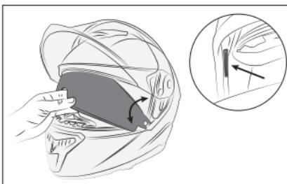
Para quitar la visera, tire de ella hacia afuera. Para volver a montarlo, engáncelo con cuidado en los soportes especiales.
