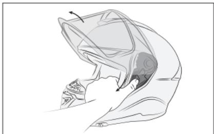
Remova a viseira desenganchando-a usando o suporte especial.
