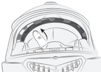
Haken Sie die Kappe ein, indem Sie das Kunststoffteil in die entsprechenden Aussparungen entlang des Rahmens einführen.
