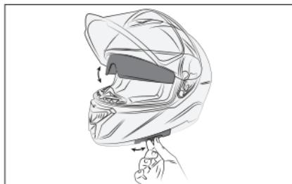
Levante e abaixe a viseira, conforme mostrado na figura, usando o controle deslizante apropriado.
