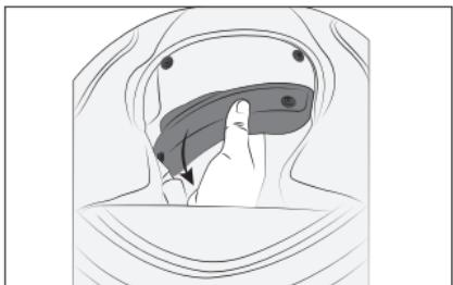
Remova a tampa soltando a parte traseira dos botões e retire-a.
