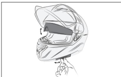
Suba y baje la visera, como se muestra en la figura, utilizando el control deslizante correspondiente.
