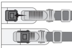
**A** - Despues de haberse puesto un casco Acerbis de la talla correcta (siguiendo cuidadosamente las instrucciones de los puntos anteriores), apriete el barboquejo con fuerza pasando el extremo de la cinta a través de los anillos en forma de "D". Ahora pase el extremo de la cinta sobre un anillo "D" y a través de la segunda (como se muestra en la fig. A) y tire de ella hasta que esté bien tensada.
