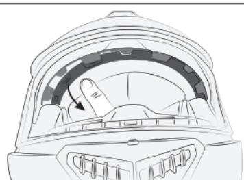
Entfernen Sie die Vorderseite, indem Sie die Innenseite entlang des Rahmens vorsichtig lösen. Um den Vorgang zu erleichtern, beginnen Sie mit der Seite des Rahmens.
