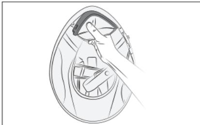
Para remover o queixo, primeiro desaparafuse a proteção do queixo na parte interna.
