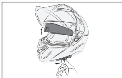
Heben und senken Sie das Visier, wie in der Abbildung gezeigt, mit dem entsprechenden Schieber.
