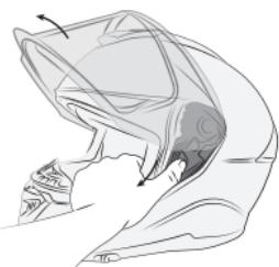
Αφαιρέστε το γείσο αποσυνδέοντάς το χρησιμοποιώντας το ειδικό στήριγμα.
