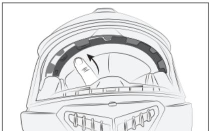
Encaixe a tampa inserindo a parte plástica nos espaços apropriados ao longo do quadro.
