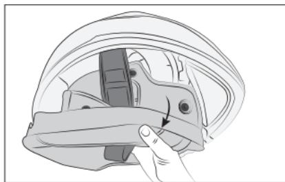
Ziehen Sie, indem Sie die Knöpfe und den Klettverschluss lösen, mit denen das Kissen befestigt ist, und entfernen Sie es. Entfernen Sie das Kissen vom Riemen.
